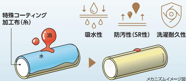
油などで汚れた布を洗濯(水に浸す)することにより、「吸水性撥油性」を発揮して、コーティング膜表面に溜まっていた油が浮かび上がり、簡単に汚れを落とすことができます。
