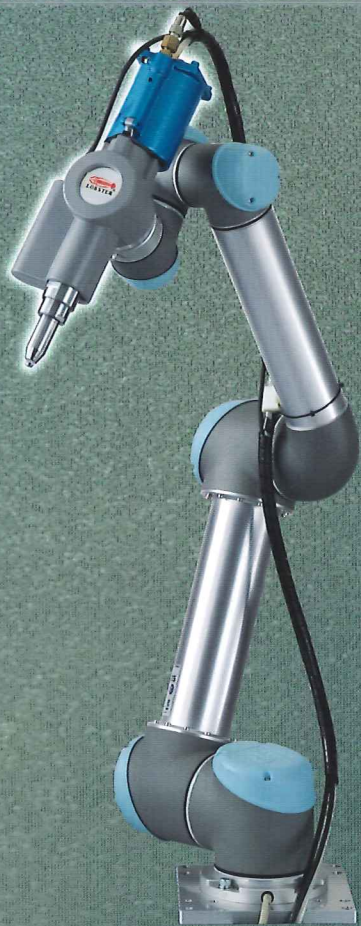
縦型エアリベッター ＋ 協働ロボット
