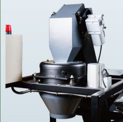
マッハセパレーター MS-050 3相 200V 0.2kW
